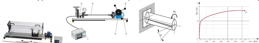
L'essai de torsion fait partie des méthodes d'essai destructif, et étudie le comportement plastique des matériaux. Dans la pratique, on se sert de cette méthode d'essai pour tester des composants qui sont tordus pendant leur utilisation, comme par exemple les vis, arbres, axes, fils et ressorts.
