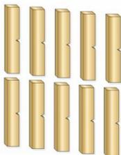
Ce jeu d'éprouvettes en V ISO est disponible en accessoire pour l'appareil de essai WP 410.
