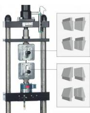
Cet accessoire, conçu pour l'appareil dessai WP 310, permet de réaliser des essais de traction sur des éprouvettes plats ou ronds.
