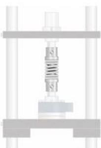
Cet accessoire, conçu pour l'appareil dessai WP 310, permet de réaliser des essais de ressort.
