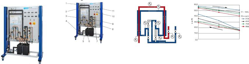
Le banc d'essai mobile permet d'étudier les propriétés caractéristiques d'un échangeur de chaleur tubulaire. L'échange de chaleur a lieu dans un échangeur à tubes coaxiaux, l'eau chaude étant envoyée à travers le tube intérieur.
