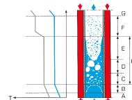
Lors de la production de vapeur, le milieu à évaporer passe par différentes formes d'écoulement en fonction de la zone de transfert de chaleur.
