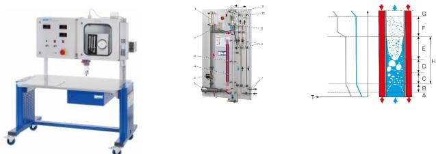
Lors de la production de vapeur, le milieu à évaporer passe par différentes formes d'écoulement en fonction de la zone de transfert de chaleur.
