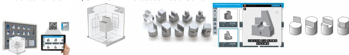
Afin de pouvoir décrire de manière satisfaisante un corps en 3D et disposer ainsi des données assurant sa reconstruction exacte et la reproductibilité de sa production, on a en règle générale besoin de plusieurs vues de ce corps.
