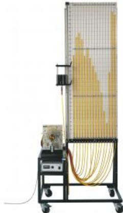
Sur les paliers lisses hydrodynamiques, le palier et le coussinet de palier sont séparés l'un de l'autre par un film lubrifiant pendant le fonctionnement.
