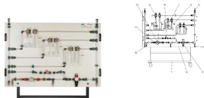
Le banc d'essai présente un système ouvert de conduites qui simule une installation domestique d'eau potable avec 4 hauteurs différentes.
