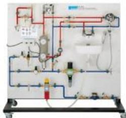
Sur le panneau de l'appareil d'essai est montée une installation d'eau potable comparable aux installations domestiques habituelles.
