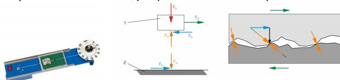
L'appareil permet de effectuer des essais de base sur le frottement d'adhérence et le frottement de glissement.
