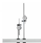
Ce jeu de comparateurs à cadran mécaniques permet de mesurer avec précision les déplacements mécaniques avec de nombreux montages expérimentaux.
