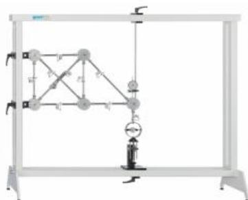
En ajoutant des barres supplémentaires, un treillis isostatique devient intérieurement hyperstatique.
