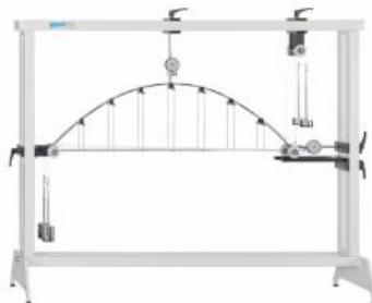
Les arcs paraboliques sont des éléments recherchés dans la technique de construction.
