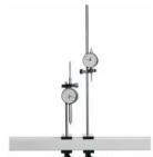
Ce jeu de comparateurs à cadran mécaniques permet de mesurer avec précision les déplacements mécaniques avec de nombreux montages expérimentaux.
