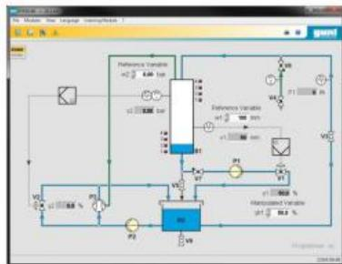
Le logiciel de conduite de procédés RT 650.60 (SCADA) a été spécialement conçu pour RT 681 et RT 682. Il est possible de raccorder simultanément les deux bancs dessai.
