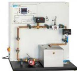
L'appareil d'essai constitue une introduction expérimentale étendue aux principes de base de la technique de régulation à l'exemple d'une régulation de débit.
