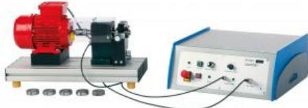
L'analyse des vibrations est un outil important pour évaluer l'état d'un palier à roulement.
