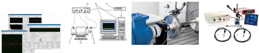
L'analyseur de vibrations assisté par ordinateur a été développé spécialement pour permettre l'interprétation des essais pour le diagnostic de machine de la série PT 500.
