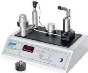
L'appareil dessaide réaliser une opération de calibrage conforme à la pratique sur un capteur de pression électronique.
