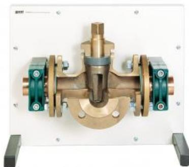
Véritable robinet à 3 voies transformé en modèle en coupe.
