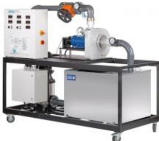
La turbine Francis fait partie des turbines à réaction qui transforment l'énergie de pression du fluide de travail en énergie cinétique dans le distributeur et dans le rotor.
