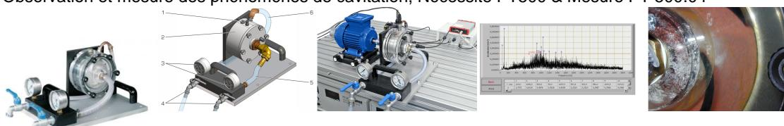
Lors de la mesure de vibrations sur les pompes, la cavitation peut jouer un grand rôle.
