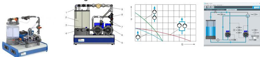
Dans les installations complexes, il est possible d'utiliser des pompes montées en série ou en parallèle. Les hauteurs de refoulement sajoutent pour le montage en série, et les débits de refoulement sajoutent pour le montage en parallèle.
