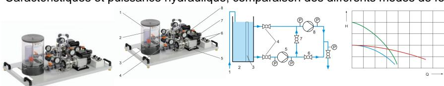
Dans des installations complexes, il est possible d'utiliser des pompes montées en série ou en parallèle.
