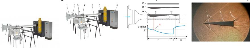
Les écoulements subsoniques et les écoulements supersonique ne se comportent pas de la même manière. Ainsi, un étranglement de la coupe transversale de l'écoulement subsonique entraîne une augmentation de la vitesse, alors que sur l'écoulement supersonique, on observe une réduction de la vitesse.
