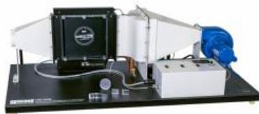
Les lignes de courant de l'écoulement stationnaire sont visualisées dans la soufflerie à l'aide de brouillard, de fumée ou de fils.
