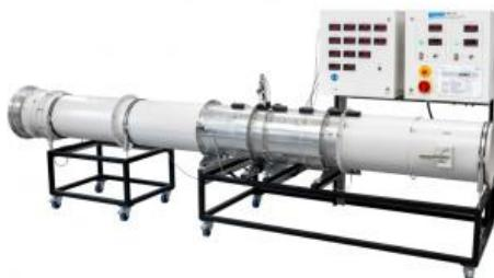
Les soufflantes axiales sont connectées en série dans les installations afin d'augmenter la pression. Lorsque deux soufflantes sont connectées en série, la augmentation de la pression est théoriquement multipliée par deux.
