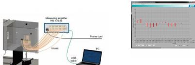
Le système HM 170.55 permet de visualiser la courbe de pression différentielle dans un logiciel.
