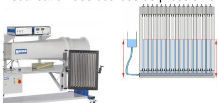
Le manomètre HM 170.50 sert à indiquer simultanément jusqu'à 16 pressions différentielles mesurées en millimètres de colonne d'eau.
