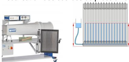
Le manomètre HM 170.50 sert à indiquer simultanément jusqu'à 16 pressions différentielles mesurées en millimètres de colonne d'eau.
