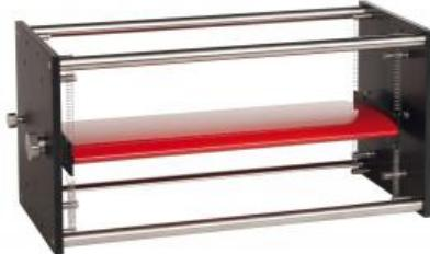
Le modèle à aile est suspendu de façon flexible dans un châssis externe à l'aide de huit ressorts. L'aile peut ainsi effectuer des vibrations torsionnelles et transversales.
