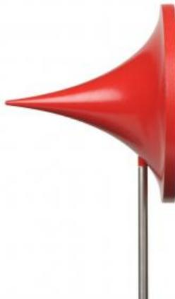
Le corps de résistance forme concave est étudié dans la section de mesure de la soufflerie HM 170.
