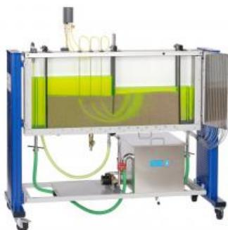
La visualisation des lignes de courant et leur représentation graphique sous la forme d'un réseau d'écoulement constituent une méthode explicite d'étude de l'écoulement d'infiltration et de l'écoulement souterrain.
