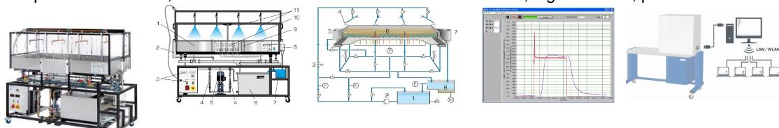
Le HM 145 permet d'étudier les écoulements d'infiltration et les écoulements souterrains après des précipitations.
