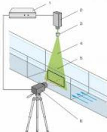
Un système PIV (Particle Image Velocimetry) permet d'enregistrer des champs de vitesse dans la section d'essai. L'accessoire HM 161.81 contient un système complet avec technique de nappe lumineuse, caméra et synchroniseur. Ce système est adapté aux mesures d'écoulement bidimensionnelles.
