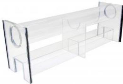
**Observation de l'écoulement et l'apparition des ressauts dans deux corps de canal différents**
