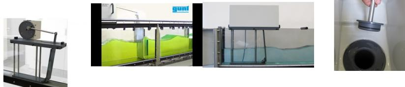
Les ondes de surface sont générées par une plaque de refoulement qui exécute un mouvement pivotant.
