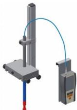
L'élément principal du tachymètre HM 160.64 est une roue à ailettes qui tourne sous l'effet de l'écoulement.
