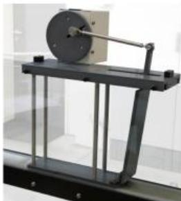
Les ondes de surface sont générées par une plaque de refoulement qui exécute un mouvement pivotant. La plaque est entraînée par un moteur avec convertisseur de fréquence par le biais d'un système bielle-manivelle.
