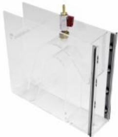
**Analyses la capacité de décharge du déversoir du siphon avec et sans ventilation**
