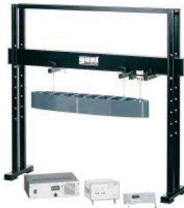
**HM 159.11 Vibrations propres sur modèle de bateau
