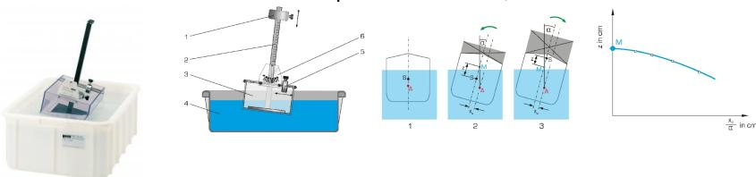
En hydrostatique, le métacentre est un point d'observation important pour évaluer la stabilité des corps flottants. La stabilité décrit la capacité d'un bateau à se redresser depuis une position gîte.
