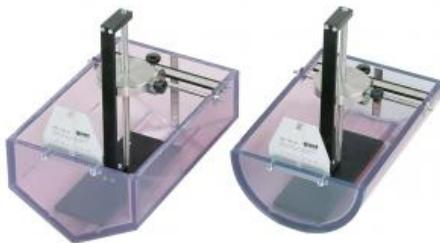
L'accessoire HM 150.39 comprend deux corps flottants transparents avec des formes de membrure différentes (bouchain vif et bouchain adouci).
