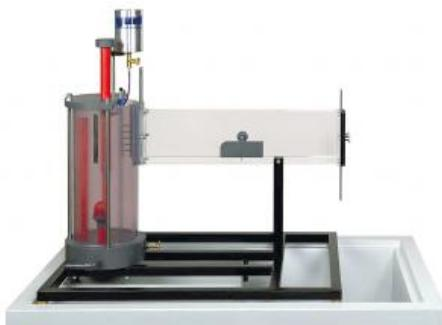
Le banc dessai HM 150.21 permet de visualiser les écoulements autour de corps de résistance et les phénomènes découlant dans des canaux ouverts.
