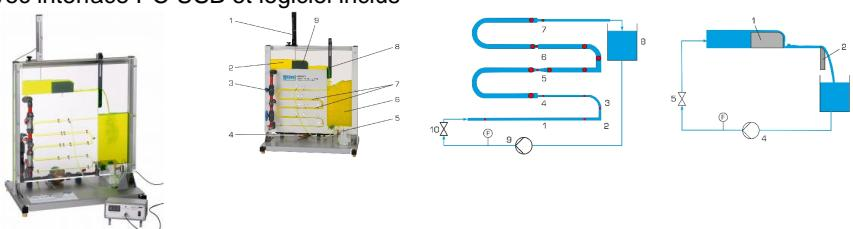
En mécanique des fluides incompressibles, on fait la distinction entre l'écoulement tubulaire et l'écoulement dans des canaux ouverts.
