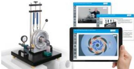
La turbine Francis fait partie des turbines à réaction qui transforment l'énergie de pression de l'eau en énergie cinétique dans le distributeur et dans le rotor.
