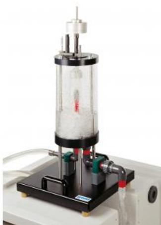
Le fait de ralentir, accélérer ou changer la direction d'un fluide en écoulement modifie sa vitesse, ce qui entraîne une modification de l'impulsion.
