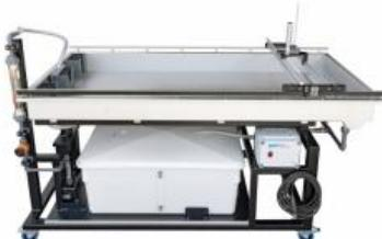
Avec HM 144, des phénomènes importants du transport par charriage dans la zone proche du lit sont montrés avec un écoulement sous-critique.
