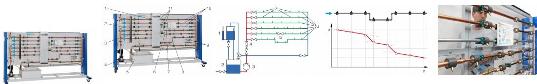
La connaissance des pertes de charge dans différents éléments de tuyauterie joue un rôle important dans le dimensionnement des systèmes de tuyauterie.
