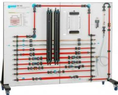
**HM 120 Pertes dans des éléments de tuyauterie (Réf. 070.12000)**
