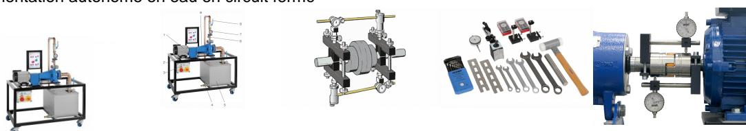
Une procédure de travail complète de réparation de machines réceptrices comme les pompes se compose des étapes de travail suivantes: montage - alignement - contrôle.
