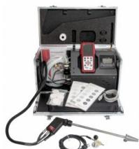
L'appareil peut être alimenté soit par une pile, soit par le secteur. On peut mettre en évidence la présence de O<sub>2</sub>, CO, CO<sub>2</sub> et oxydes d'azote dans les fumées d'installations de combustion domestiques avec mesure simultanée de la température des fumées et de l'air de combustion. Outre un afficheur, l'appareil possède une imprimante thermique et une interface USB. L'interface USB permet de raccorder un PC.
