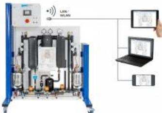
Le système modulaire HL 320 permet la réalisation de tests pour la production, le stockage et l'exploitation de la chaleur issue des énergies renouvelables.
